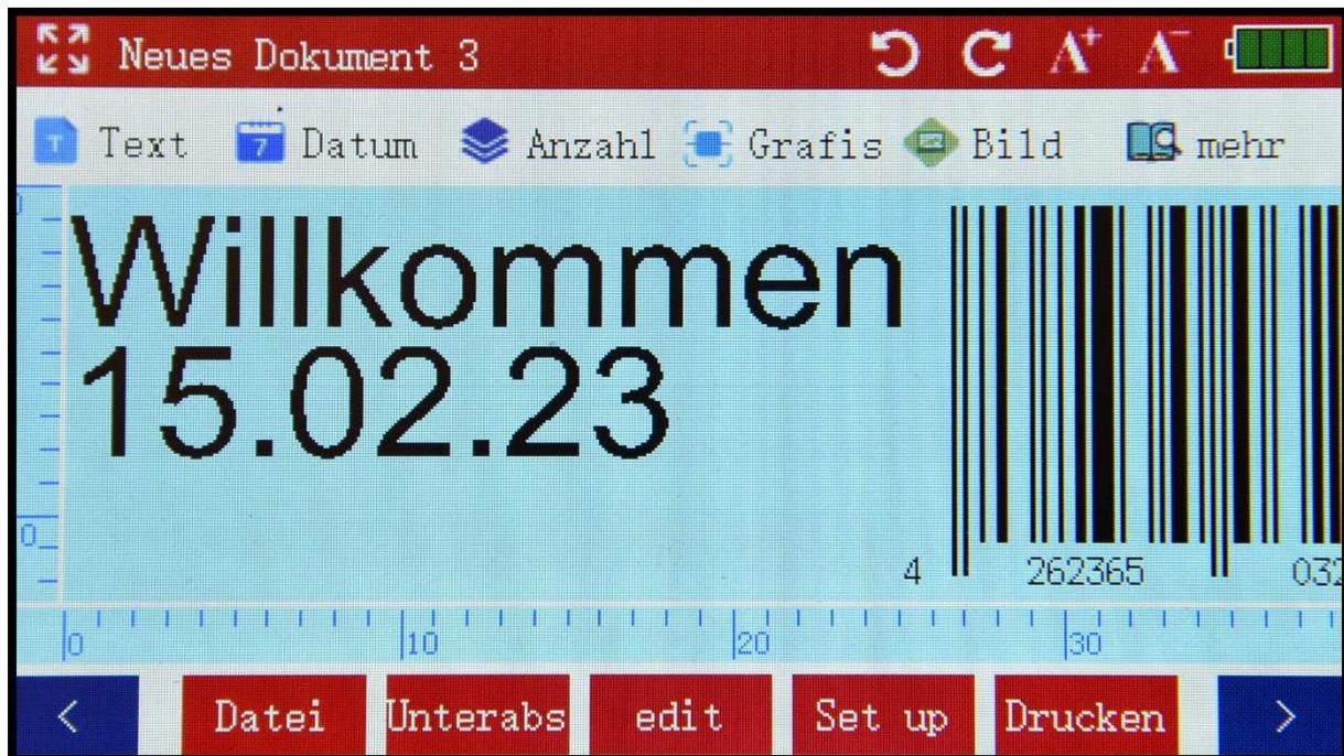
Ganz oben Links im Hauptmenü befinden sich 4 voneinander weg zeigende Pfeile. Dieser Menüpunkt öffnet eine Ansicht auf ihr Design, die einfaches und präzises Verschieben einzelner Bildelemente ermöglicht:
