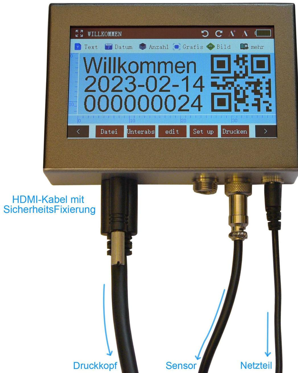
Nach dem Anschluss der Kabel und der Montage am Förderband, können Sie das System einschalten. (Der Powerknopf befindet sich auf der rechten Seitenwand des Monitors).
